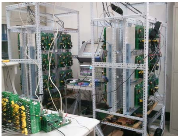
图9 三相“背靠背”MMC实验样机
